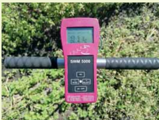
Abbildung 3: Bodenfeuchtesensor SWM 5000 (Hendrik Roosmann)
