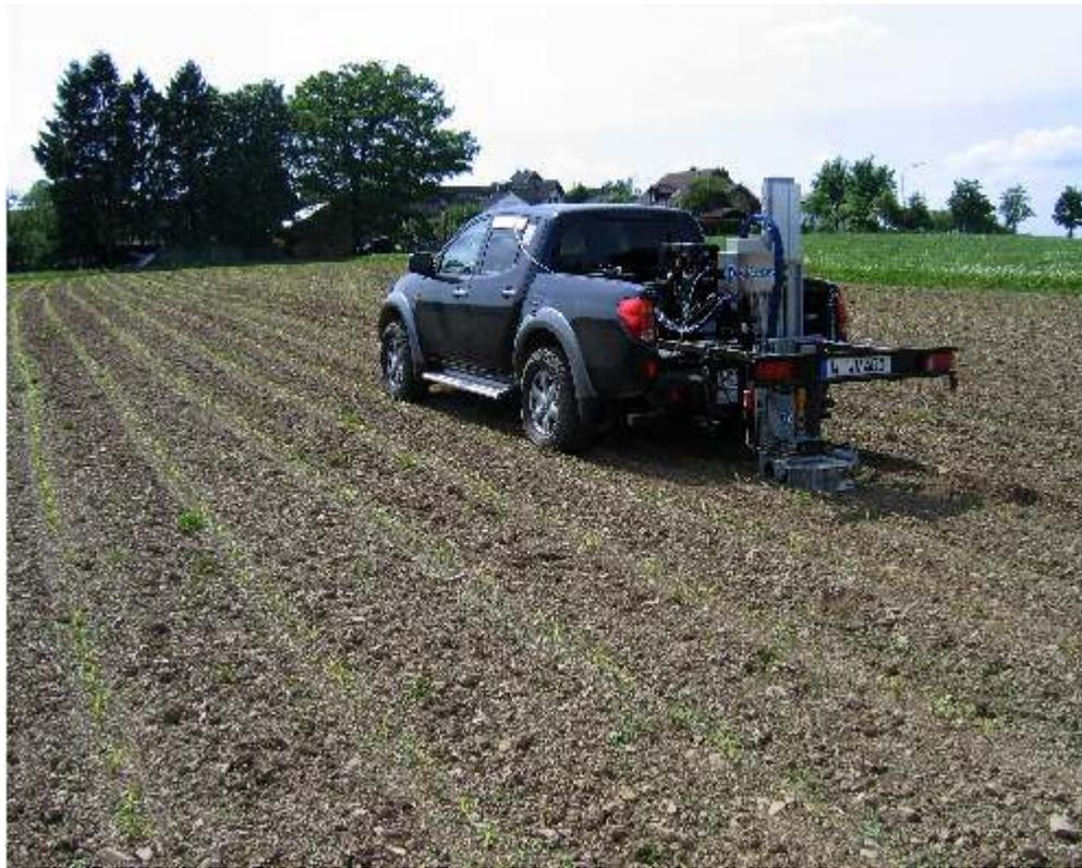
Die automatisierte Entnahme von Bodenproben mit Spezialfahrzeugen ermöglicht in Kooperationsgebieten einen zeitnahen und flächendeckenden Überblick über die Nährstoffsituation im Boden.
