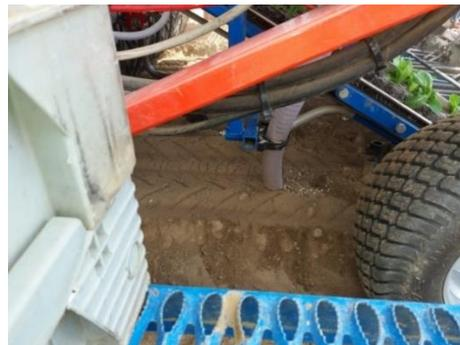
Abb. 136: Schlauchleitung zur Ablage des Düngebandes
