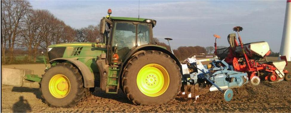
Abb. 105: Bodenlockerungsgerät
