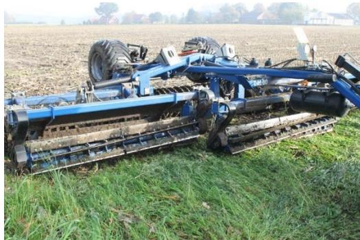
Abb. 124: DalBo-Messerwalze in aktiv schneidender Arbeitsstellung bei der Vorführung in Sandhafer (Quelle: Ökoteam der LWK NRW)
