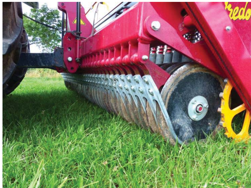
Abbildung 11: Bei größeren Lücken in der Grasnarbe ist der Einsatz von speziellen Durchsaatsämaschinen sinnvoll um den Nachsaaterfolg zu erhöhen
