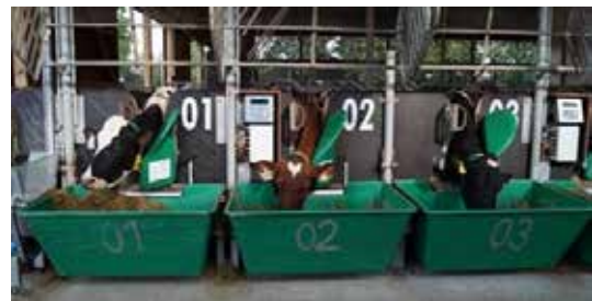
Die Futteraufnahme wurde tierindividuell mit Futterwiegetrögen erfasst
